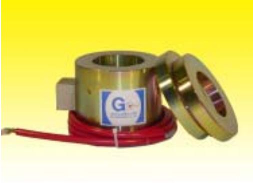
진동현식 하중계는 구조물에 작용하는 하중을 정확하게 측정하기 위한 것으로 토질 및 기초 분야에서 기초구조의 부재, 흙막이공사의 버팀대 또는 굴착사면의 보강용 어스앵커에 작용하는 인장력 및 압축력을 측정하여 공사진행 또는 완료 후의 지반이나 구조물의 변형을 예측을 할 수 있도록 설계되었다.
