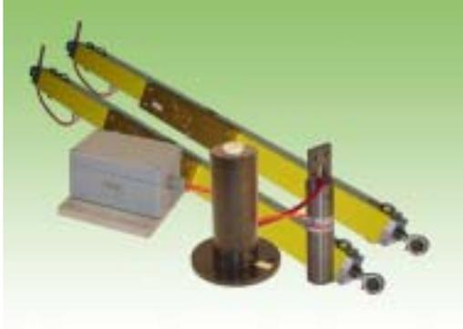
ELECTROLYTIC 경사계는 지반이나 암반의 측면 거동 (Lateral Movement) 또는 다리나 건물, 옹벽 등 인간이 만든 구조물의 기울기를 원거리에서 지속적인 측정을 하고자 고안 되어있습니다.
